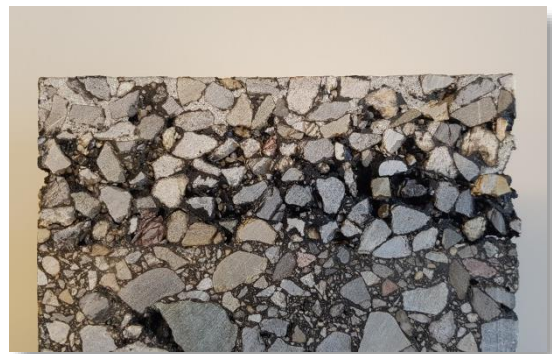
Unvollständig verfüllter VB 11 (fehlende Mat.-Bilanz)
