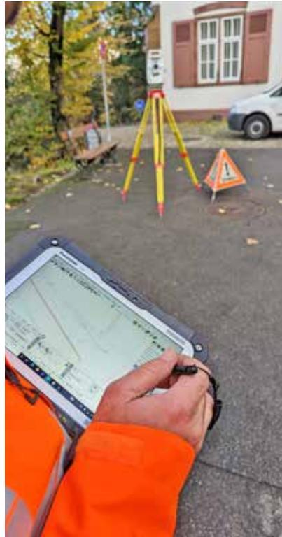
FX Survey im Einsatz mit Leica TS16.
