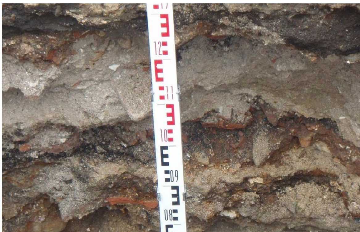
Die Haus- und Gewerbeabfälle liegen in feinen Schichten übereinander. Bauschutt, Asche und Aushub wechseln sich ab. Eine getrennte Entsorgung ist nicht möglich. Quelle: AUE
