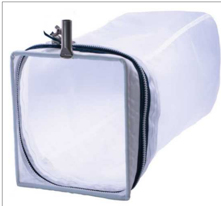
Abbildung 11: Kick-Sampling-Netz zur Entnahme flächenbezogener Kleintierproben in Fliessgewässern.
