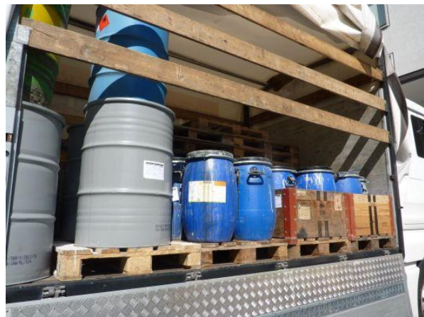
Beispiel eines Gefahrguttransports ohne Ladungssicherung und mit Fässern deren gefährlicher Inhalt teilweise ausgetreten ist.
