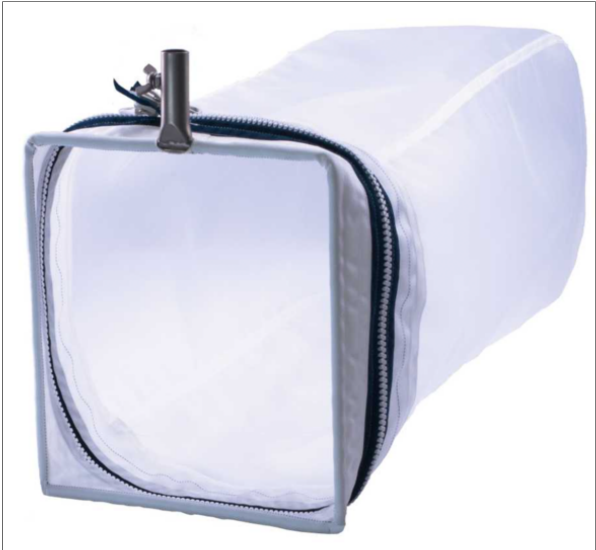
Abbildung 5: Kick-Sampling-Netz zur Entnahme flächenbezogener Kleintierproben in Fliessgewässern.
