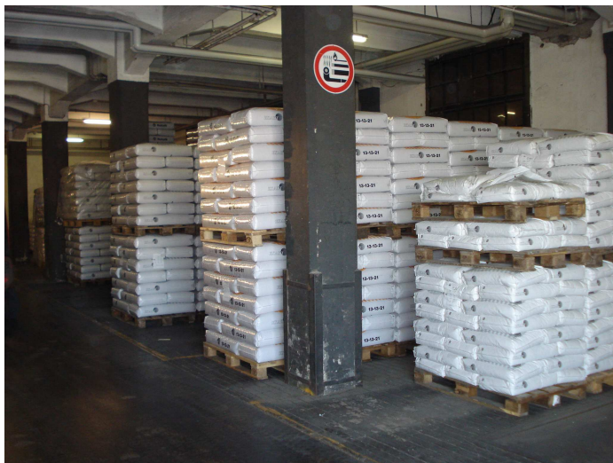
Düngemittel in Blocklagerung mit Sicherheitsabständen
