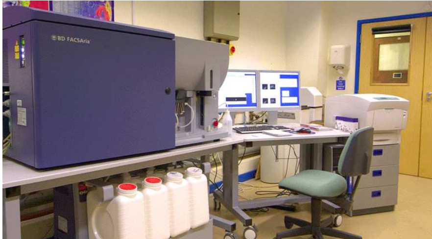
Fluorescence- Activated Cell Sorter (FACS): Je nach Modell können daraus infektiöse Aerosole freigesetzt werden. Aus räumlichen Gründen kann das Gerät meist nicht in eine Sicherheitswerkbank platziert werden. Foto: Becton Dickinson
