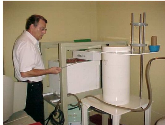
Gammaskpektrometer zur Analyse der aktivierten Kunststoffproben
