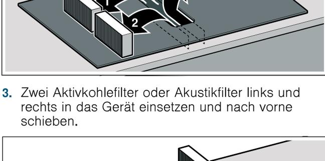
3. Zwei Aktivkohlefilter oder Akustikfilter links und rechts in das Gerät einsetzen und nach vorne schieben.
