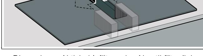
4. Die anderen Aktivkohlefilter oder Akustikfilter links und rechts in das Gerät einsetzen.
