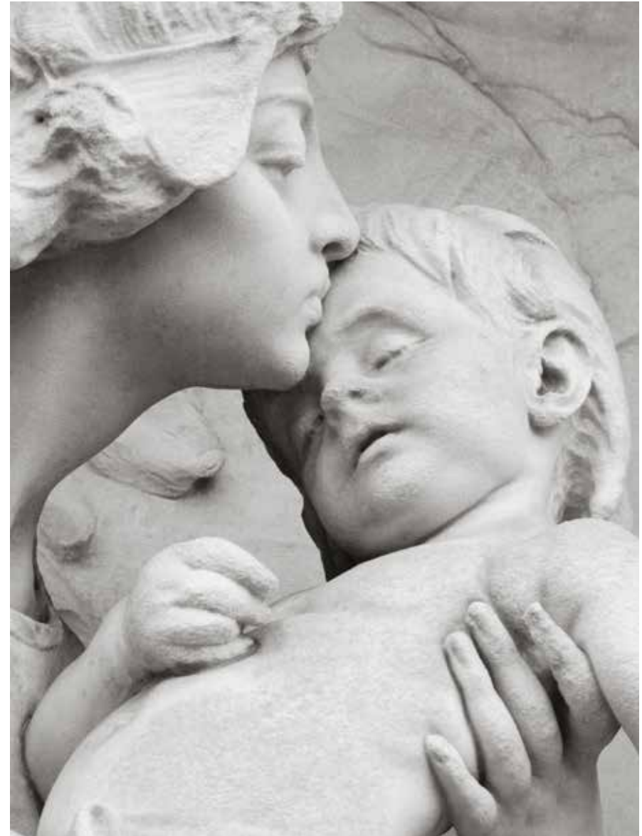
Enrico Butti, Grabmal für Helene Rosine La Roche, typisches Schadensbild mit «zuckernder Oberfläche»
