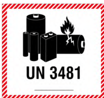
Illustration 5 : Marquage nécessaire pour les batteries au lithium montées dans les équipements (UN 3481)
