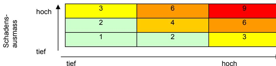
Abbildung 2: Schema eines Risikoprofil Eintretenswahrscheinlichkeit
