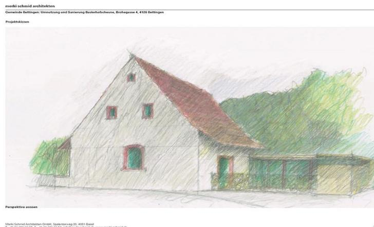
Durch den neuen Dachaufbau auf die bestehende Lattung bleibt das Bild der heutigen Konstruktionsuntersicht erhalten. Durch das seitliche Aufmauern und das Anbringen eines Dämmputzes ist die Mehrhöhe an der Fassade nicht sichtbar. Mit dem Aufmauern der Giebel nähert man sich der alten Proportion, welche durch die Strassenerhöhung verloren gegangen ist.
