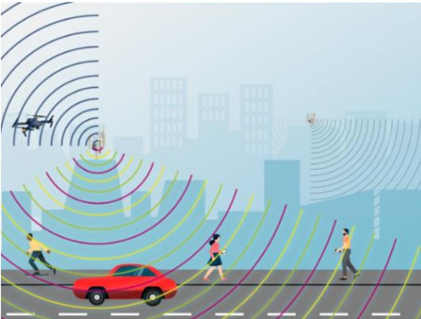
**Konventionelle Antennen** weisen eine Abstrahlcharakteristik auf, die räumlich konstant ist oder nur innerhalb begrenzter Bereiche manuell oder ferngesteuert bei Bedarf angepasst werden kann.
