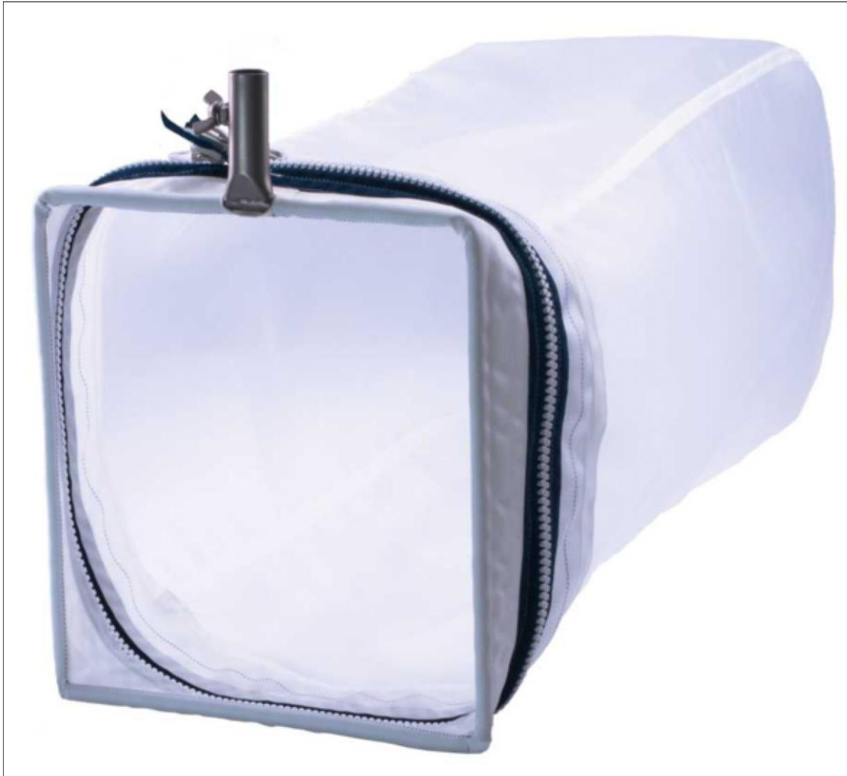
Abbildung 5: Kick-Sampling-Netz zur Entnahme flächenbezogener Kleintierproben in Fließgewässern.
