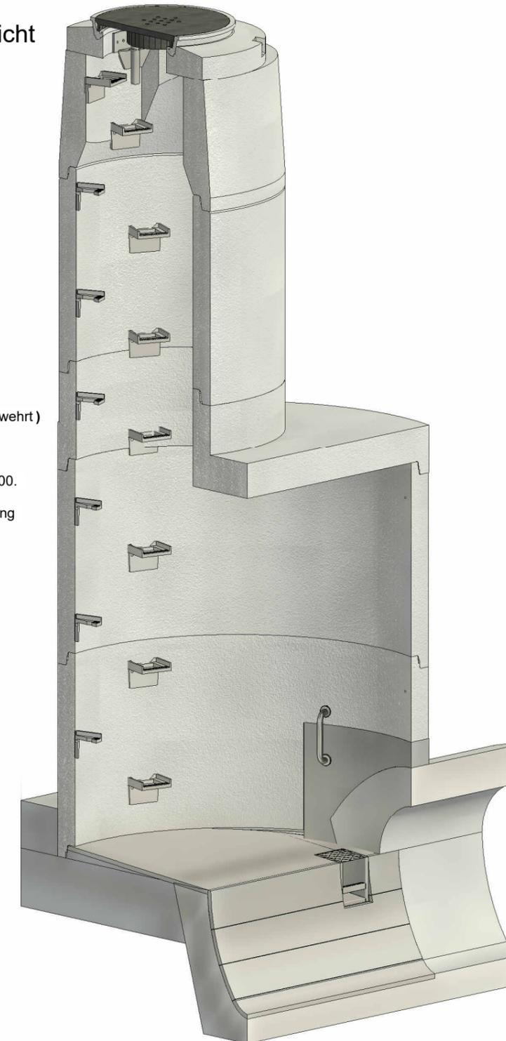
Aussparung in Schachtring mit Vergussmörtel und eingelegtem Dichtungsband verschliessen
