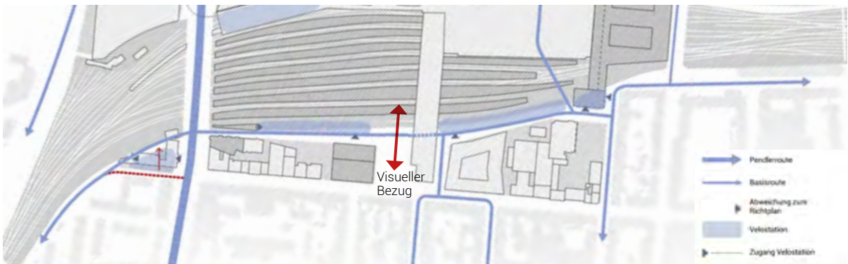
Abb.: 81 Weiterführung Fussweg entlang der Gleise, Schaffung neuer Velostellplätze entlang Meret Oppenheim-Strasse und Sicherstellung visueller Bezug Gleisfeld - Meret Oppenheim-Platz
