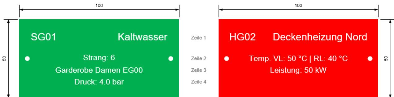
Abbildung 10: Armaturen, Verteilerabgänge usw. Beispiele
