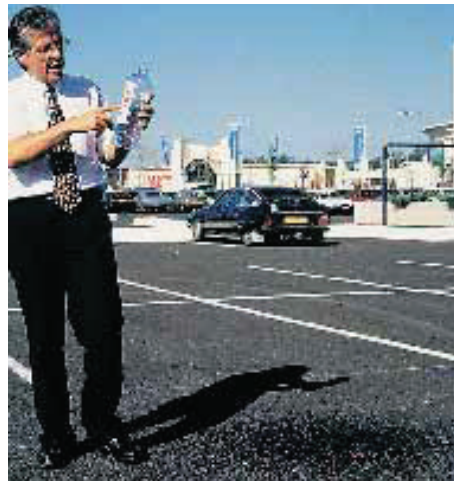
«Vittel-Test»: Die 1,5 l Wasser versickern augenblicklich
