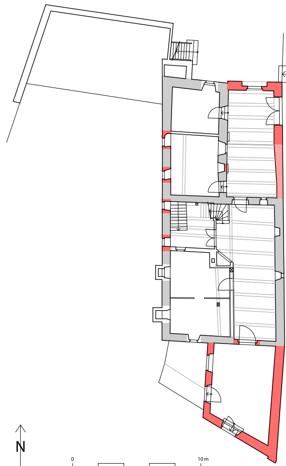
Grundriss des Kellergeschosses. Die graue Markierung zeigt die Gebäude von 1390, die roten Partien bezeichnen die verschiedenen Erweiterungen.
