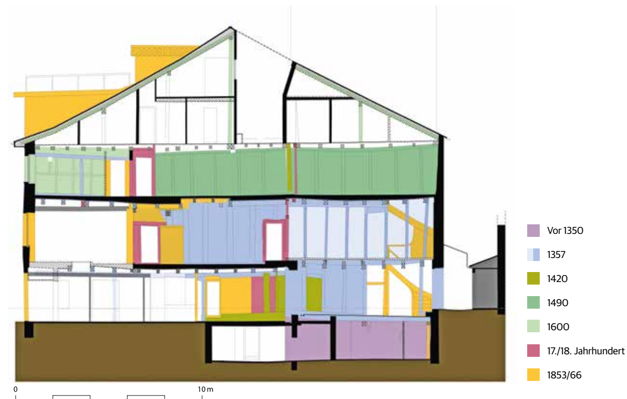
Schnitt durch das Haus zum Oberen Waldshut, die Rheingasse liegt links. Im Innern ist die Ständerwand eingezeichnet, die das Haus teilt.
