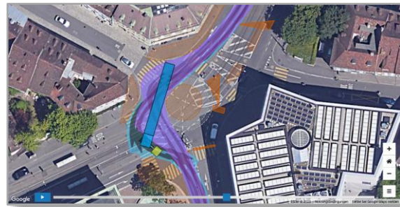
Normalprofil für Ausnahmetransporte im Kanton Basel-Stadt und ein modelliertes Fahrzeug Typ I
