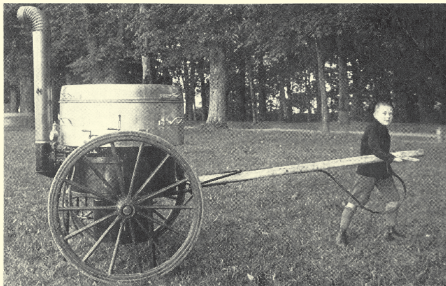
Daß Loders Apparat die Bezeichnung «Kanone» erhielt, wird aus diesem Bilde (fahrbarer Tiefdruckkessel) klar.
