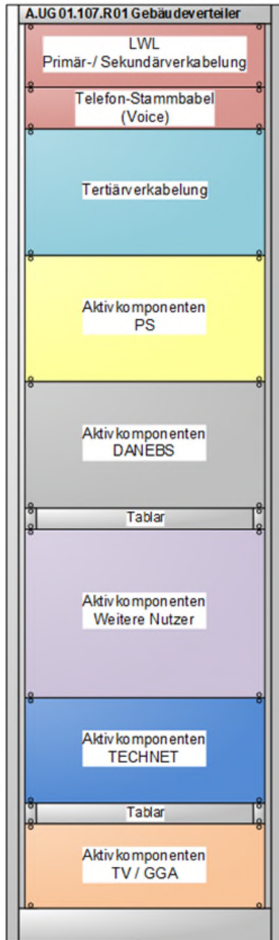
Abbildung 5: Musteraufbau Verteilerdisposition <72 UKV-Anschlüsse
