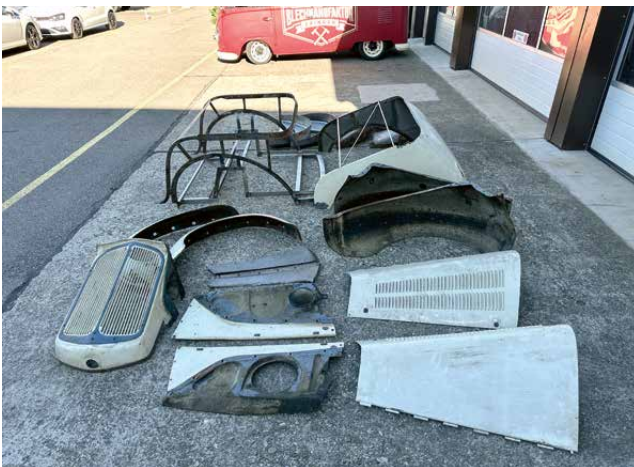
Karosserieteile auf dem Weg zum Sandstrahlen und Ablagen.
