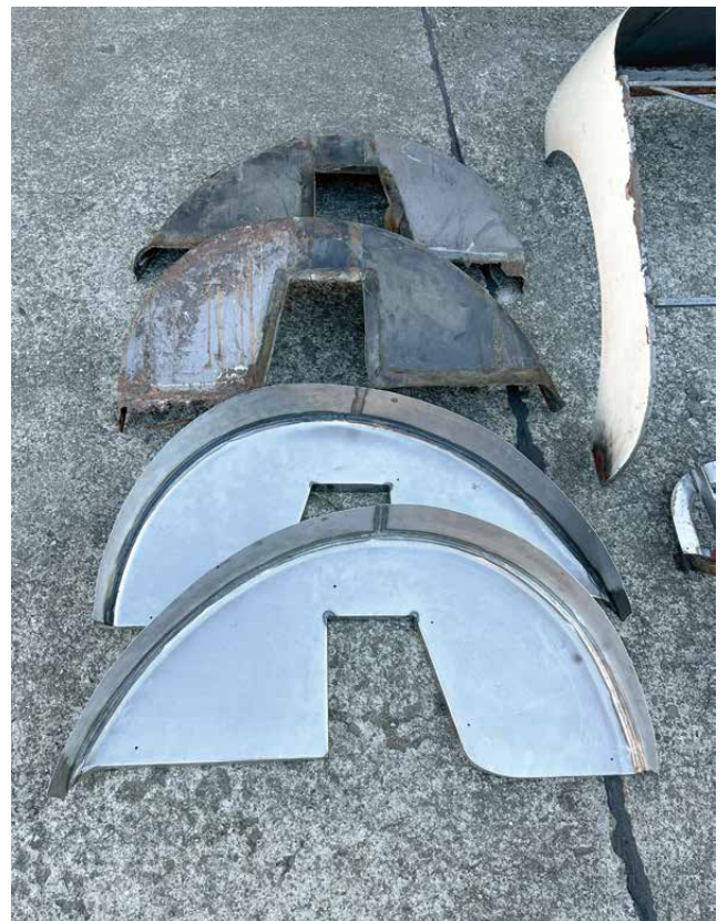
Die alten, von Rost zerfressenen hinteren Innenkotflügel und davor die exakten Kopien.
