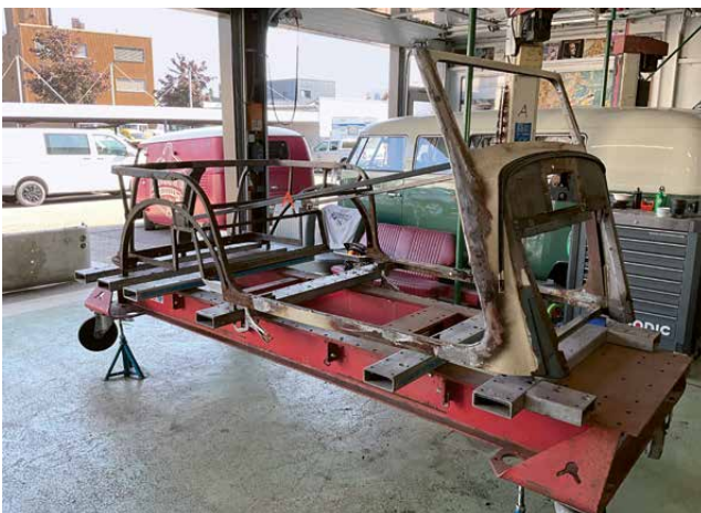
Die noch unzerlegte Karosserie auf der Richtbank.
