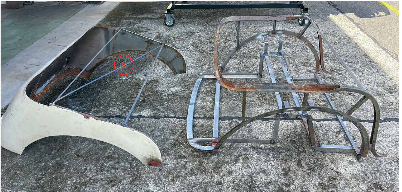
Gut sichtbar die neu eingebauten Karosserieteile. Die mit A bezeichneten Streben dienen zur Stabilisierung und werden nach dem Ablagen wieder entfernt.
