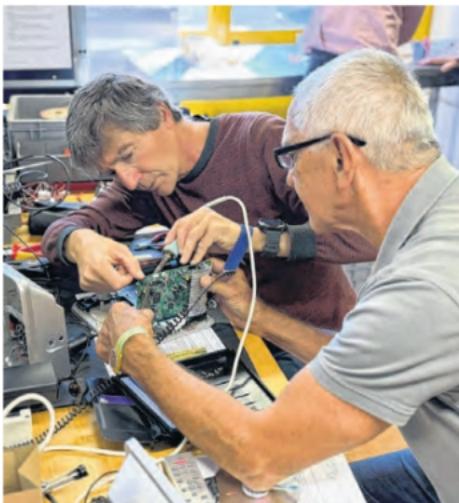
Ein defekter CD-Player ist in seine Bestandteile zerlegt worden und wird nun genaustens begutachtet.
