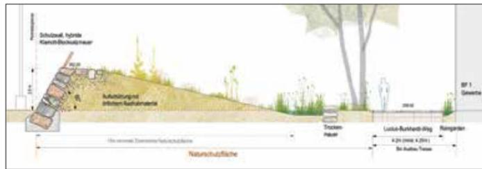
Schnitt A (Detail Schutzwall)
