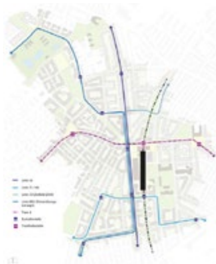
ÖV-Konzept Szenario «Bahnhof»: neue, direkte Buslinie nach Bachgraben via Grünkorridor («Badstrasse»), Umlegung Buslinien 31 und 48 zum Bahnzugang Süd.
