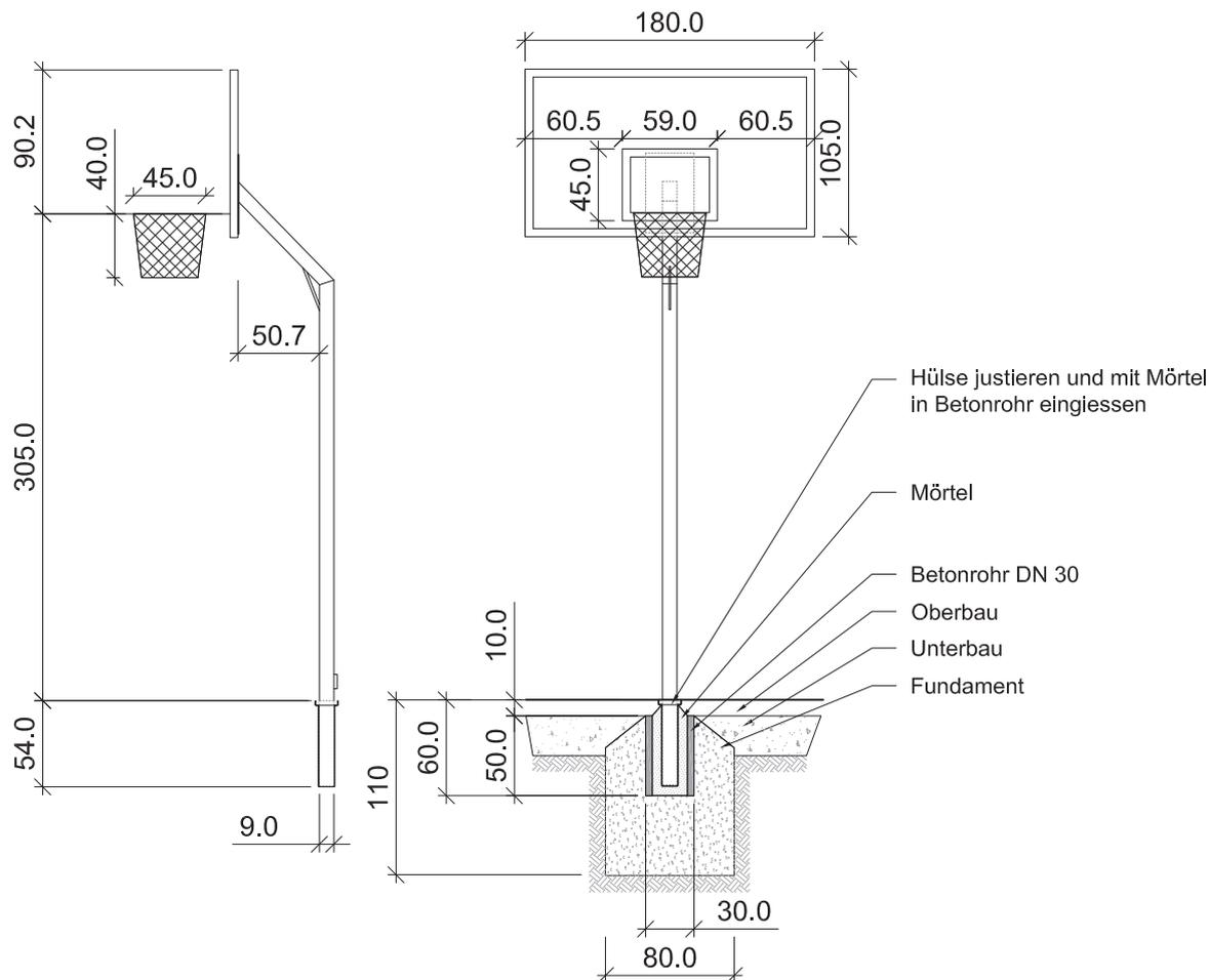
Abb. 206.01a Regelquerschnitt Korbballfundament
