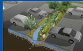
Retentionmulden können gut in den Stadtraum integriert werden wie in Parkplätze oder Strassenräume.
