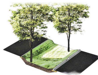
Detail Versickerungsmulde Lysbüchelstrasse und Kabelstrasse
