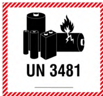
Abb. 5: Erforderliche Kennzeichnung für Lithium-Batterien in Ausrüstungen (UN 3481)
