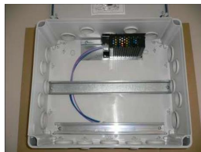
Bild 5: Türdose mit Netzteil und Hutschiene
