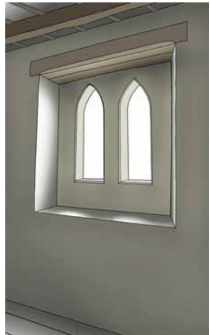
Das Doppelfenster in der Rekonstruktion. Der Sturzbalken war an der Kante mit einer breiten Fase versehen.
