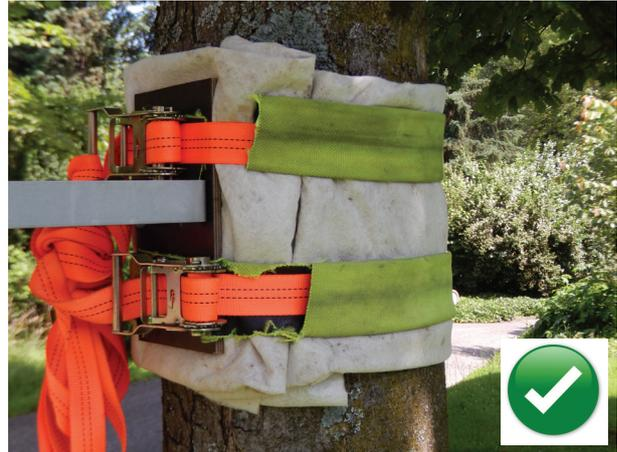
**Richtig:** Gegenstand auf Holzplatte zur Druckverteilung montiert und mit breiten Gurten auf guter Abpolsterung angebracht.
