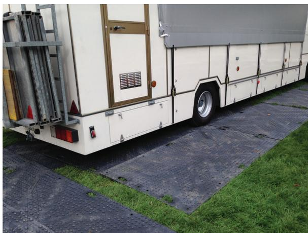
*Einsatz von Kunststoffplatten bei Befahrung (je nach Modell für Fahrzeuge bis 15 t geeignet)*
