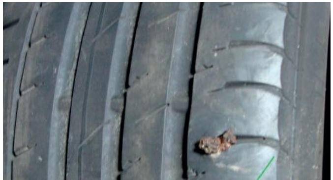
Kleinere Verletzung, mit Dichtmittel repariert.
