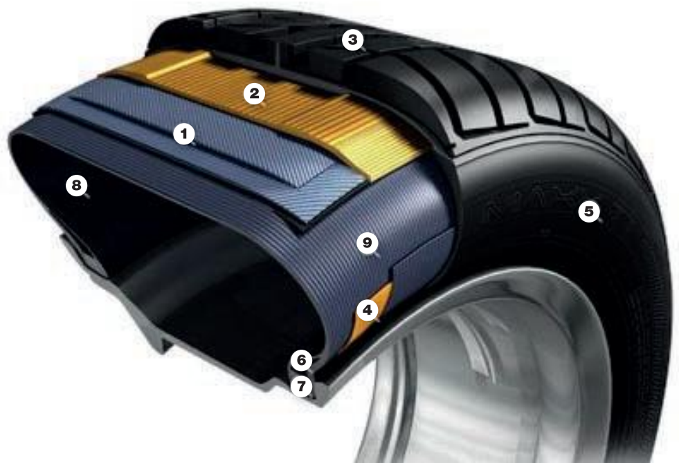
1 Stahlgürtel, 2 Abdecklage, 3 Laufstreifen, 4 Verstärkerstreifen, 5 Seitenwand, 6 Kernreiter, 7 Wulstkern, 8 Innerliner, 9 Karkasse. Quelle: Reifen24.de
