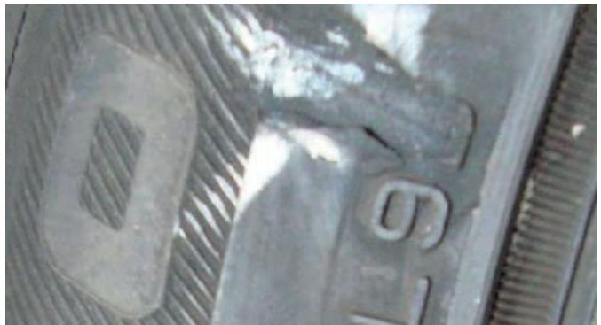
Kleine Schrammen, Stahlchord und Abdecklage nicht sichtbar.
