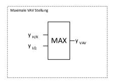
yH/K= Stellsignale Regler Heizen / KühlenyLQ= Stellsignale Regler LuftqualitätyVAV= Stellsignale VAV
