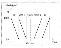
9zuL= Temperaturfühler ZuluftWzuL-Temp.= Sollwert ZulufttemperaturyT= Ventilstellung temperaturgeführtLE= LufterhitzerLK= LuftkühlerWPC H= Wörmerückgewingung Heizen
