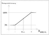
= Temperaturfühler Zuluft  $\vartheta_{\text{ZUL}}$  $\vartheta_{\text{WRG VL}}$ = Temperaturfühler WRG Vorlauf = Sollwert Zulufttemperatur WZUL-Temp. = Sollwert Vereisungsschutz W-2°C = Stellsignal Regler Winter  $y_{\text{Winter}}$
