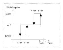
$\vartheta_{ABL}$  = Temperaturfühler Abluft  $\vartheta_{AUL}$  = Temperaturfühler Aussenluft
