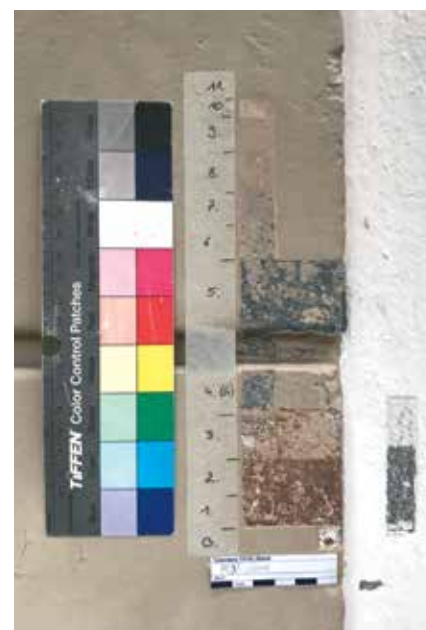
Farbschnitt an der Eckquaderung des Bockstecherhofs: Auf dem Sandstein (0) folgen drei ältere Anstrichschichten. Die graublauen Schichten 4 (Grundierung) und 5 (Deckanstrich) gehören zur Bauphase um 1844 und sind auch auf den Putzflächen nachgewiesen (rechts). Die Schichten 6–11 belegen die jüngeren Anstrichfolgen.
