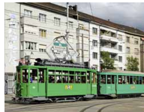
Der historische Motorwagen Be 2/2 Nr. 156 mit dreiaxligem Anhänger Nr. 1303 bei der Haltestelle Dreirosenbrücke. Der Motorwagen wurde 1920 in Dienst gestellt und ist seit 2011 als Museumsfahrzeug unterwegs.
