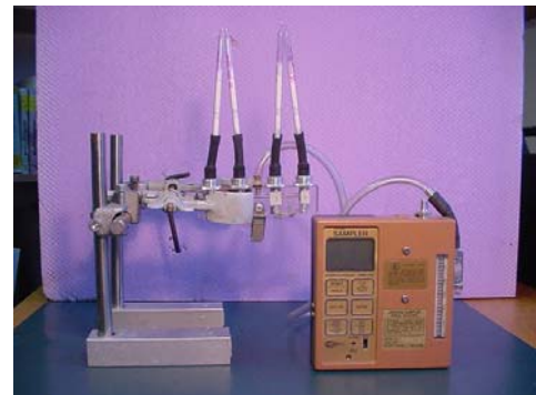
Apparatur für Raumlufthmessungen
