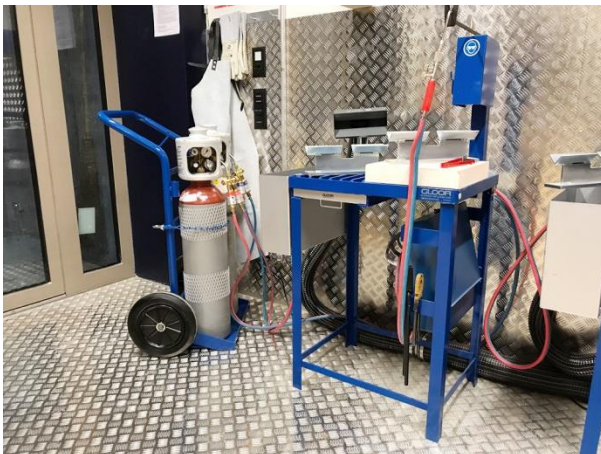
Bild 7 – Einzelarbeitsplatz mit Quellenabsaugung
