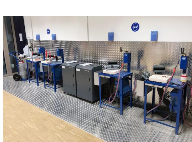
Bild 8 – Mehrfcharbeitsplätze mit Quellenabsaugung
