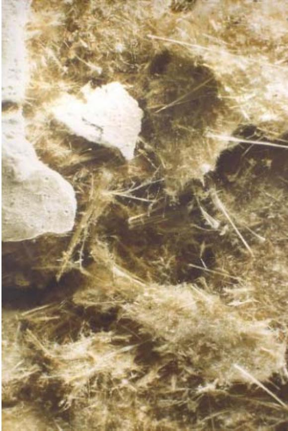
*Vergrößerung eines Spritzasbestbelags. Zu sehen sind Fasern aus Mineralwolle und lange, spitze Asbestfaserbündel, Foto: SA*
