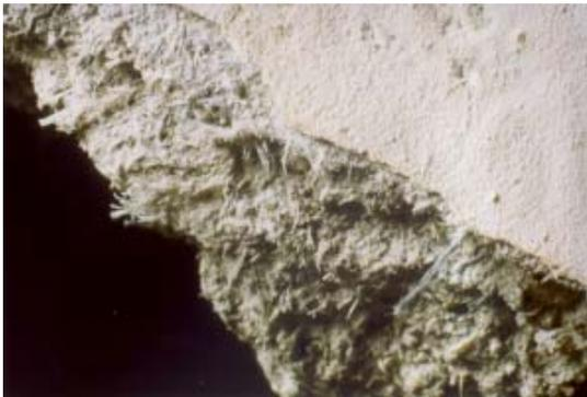
*Zerbrochene Asbestzementplatte mit sichtbaren Asbestbüscheln, Foto: SA*
