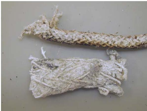
Asbestschnüre. Verwendung zur Abdichtung an brandgefährlichen Stellen, Foto: JMF/SLE, IST
