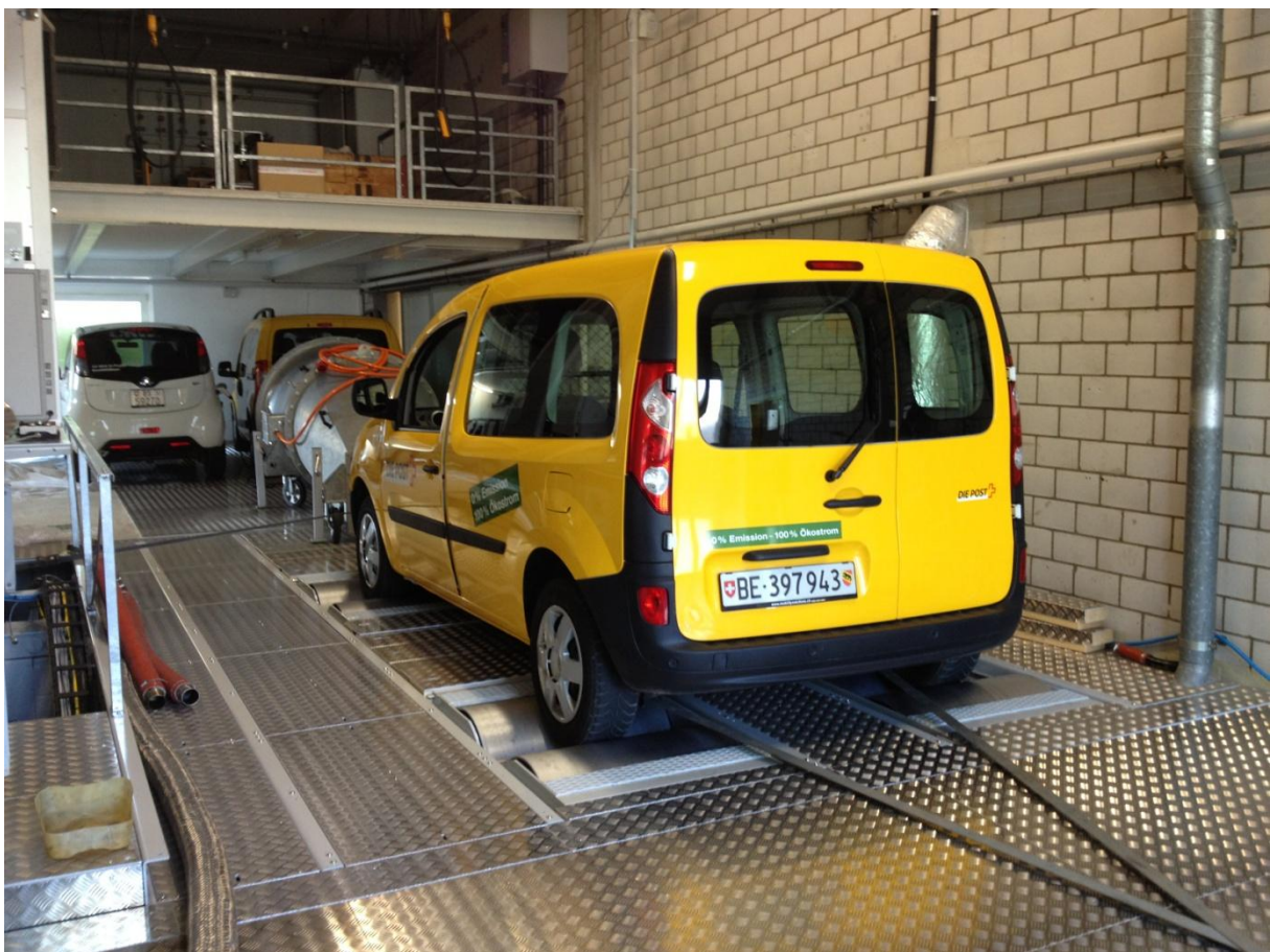
Abbildung 9 Messen des NEFZ-Zyklus beim Renault Kangoo Z.E. auf dem 2-Achsenrollenprüfstand der BFH
