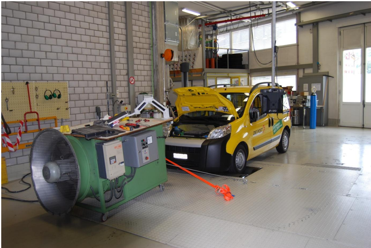
Abbildung 8 Messen des NEFZ-Zyklus beim E-Fiorino von MicroVett auf dem 1-Achsenrollenprüfstand der BFH
