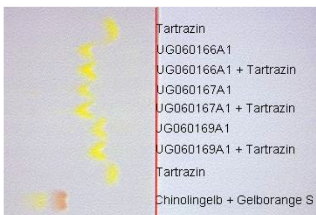
Abbildung: Nachweis von Tartrazin mittels Dünnschichtchromatographie. Matrixeffekte werden durch Aufstocken sichtbar.
