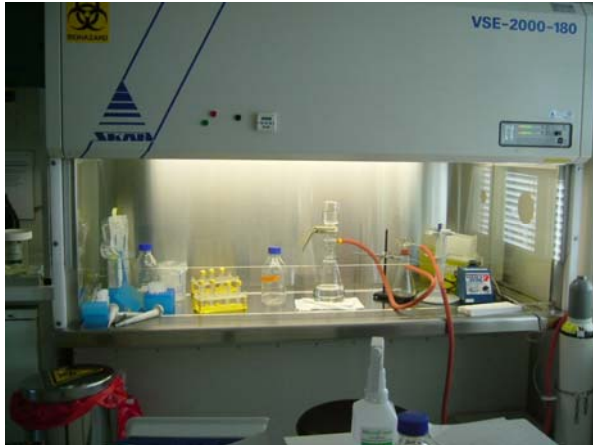
Mikrobiologische Sicherheitswerkbank zum Schutz vor infektiösen Aerosolen
