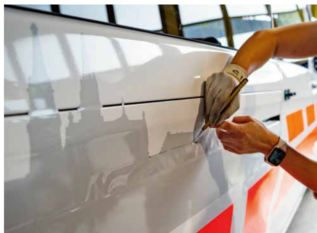
Die Foliererin bringt die Basler Skyline passgenau auf das Fahrzeug.
