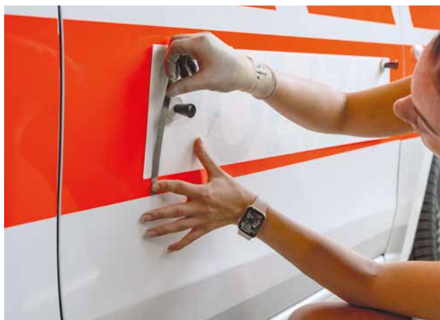
Millimetergenau wird die Folie an der Karosserie ausgerichtet.
