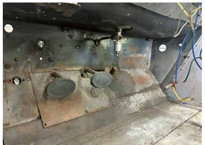
Blick auf den Benzinahn über den Pedalen: Die Treibstoffzufuhr zum Motor erfolgt noch manuell.
