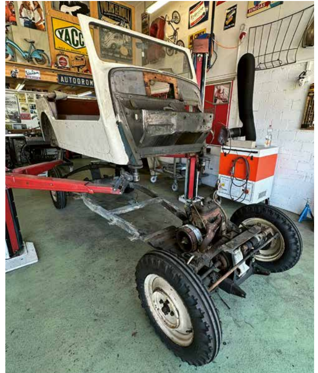
Chassis und Karosserie sind getrennt, die Restaurierung ist im Gange.
