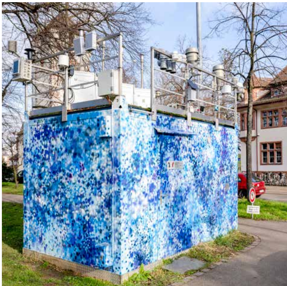
Auf dem Dach des Messcontainers, hier im St. Johannis-Quartier, sind die Luftansaugvorrichtungen, Staubsammler und Messgeräte für die Wetterparameter installiert
