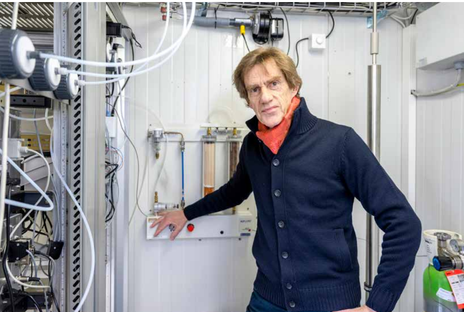
Andrea von Känel, Leiter des Lufthygieneamts beider Basel, erklärt, wie Aussenluft vom Dach des Messcontainers den Analysegeräten zugeführt wird
