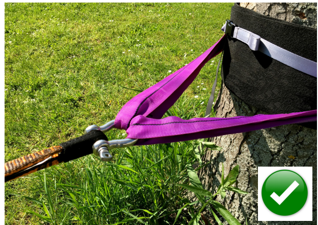
Korrekt angebrachte Befestigungsgurte
