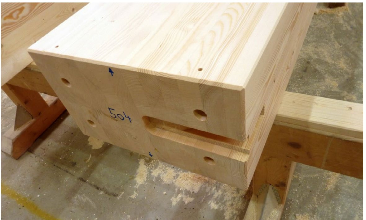
Ein fertig zugeschnittener Pfosten aus der Leimpresse rechts Foto: Roth Burgdorf AG
