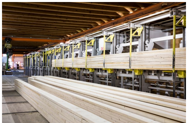
Ein fertig zugeschnittener Pfosten aus der Leimpresse rechts Foto: Roth Burgdorf AG
