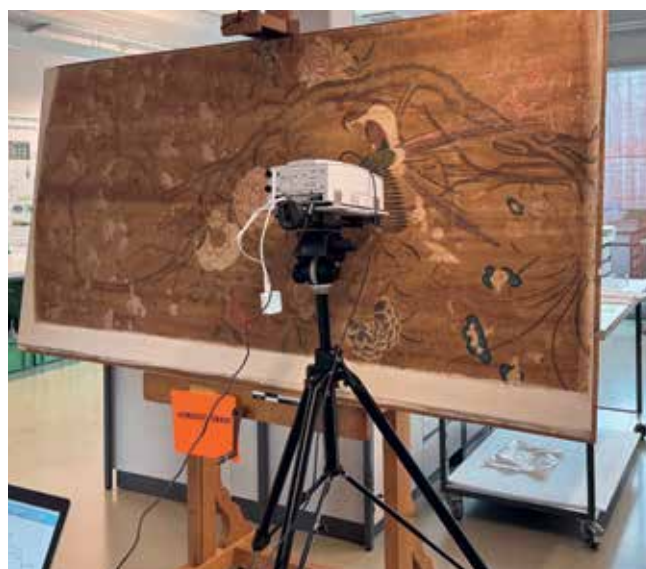
Untersuchungen des ausgebauten Paneels der chinesischen Tapete im Sammlungszentrum des Schweizerischen Nationalmuseums in Affoltern am Albis. Links: Untersuchung mit dem Digital-Mikroskop Dino-Lite. Rechts: Durchführung der mobilen FTIR-Analyse (Fourier-Transformations-Infrarot-Spektroskopie).
