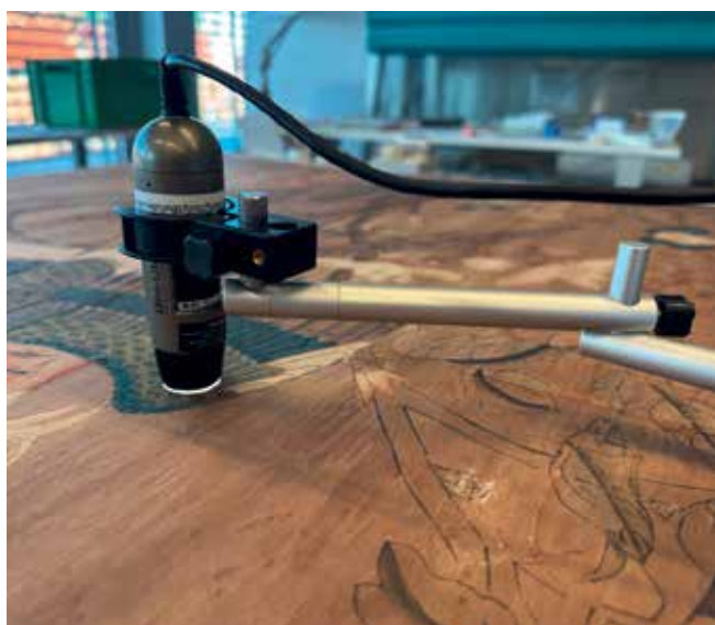
Untersuchungen des ausgebauten Paneels der chinesischen Tapete im Sammlungszentrum des Schweizerischen Nationalmuseums in Affoltern am Albis. Links: Untersuchung mit dem Digital-Mikroskop Dino-Lite. Rechts: Durchführung der mobilen FTIR-Analyse (Fourier-Transformations-Infrarot-Spektroskopie).
