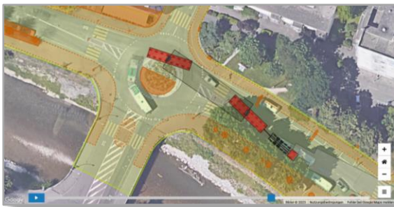
Beispiel einer zweidimensionalen Befahrbarkeitsprüfung
