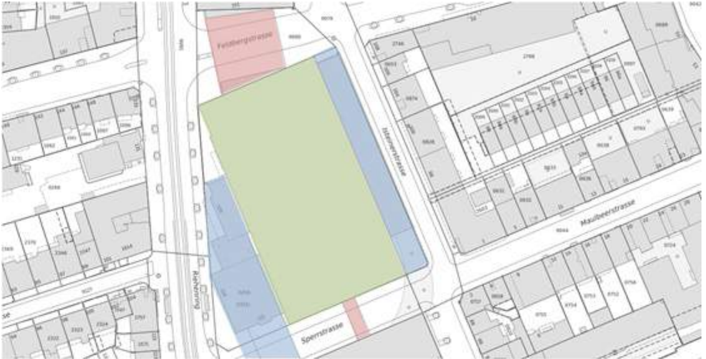
Areal Messehalle 3: Vom Neubau betroffen ist die entsprechende Parzelle (grün). Der Anbau zur Riehenstrasse und die Rampe zur Tiefgarage der Messehalle 1 («Hotz-Bau») sollen erhalten bleiben (blau). Die Brücke über die Feldbergstrasse sowie die Passarelle über die Sperrstrasse sollen abgerissen werden (rot). (Quelle: Städtebau & Architektur Basel-Stadt)
